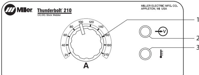
1. Регулировка сварочного тока
