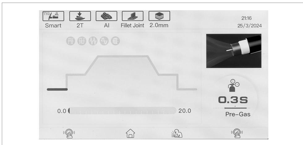
После выбор всех предустановок, аппарат подбирает оптимальный сварочный ток, а в нижней части экрана будут показаны рекомендации по расходу газа, диаметру вольфрамового электрода, диаметру присадочного прутка. Пользователь самостоятельно может внести изменения: например, выбрать форму волны, отрегулировать сварочный ток, перейти в режим PULSE и другие корректировки.
