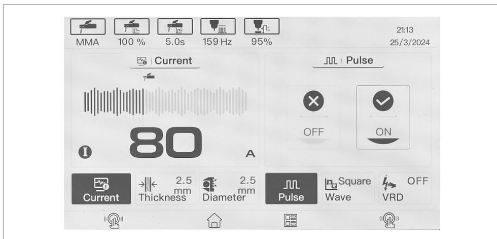
Нажав на передней панели кнопку «файл / папка» в режиме MMA, пользователь может настроить сварочные параметры и активировать вспомогательные функции.
