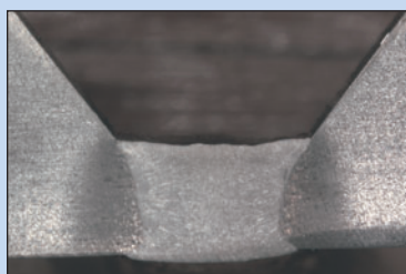
Сварка RMD® углеродистых сталей
