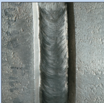
Сварка нержавеющей сталей
