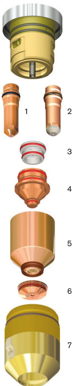
По сравнению со стандартным медным электродом технология SilverPlus в среднем увеличивает срок службы электрода вдвое за счет более глубокого прогорания. Для систем регулировки высоты резака в зависимости от напряжения, расстояние между резаком и заготовкой будет сокращаться по мере прогорания электрода. Для этого может потребоваться настройка напряжения дуги в системе регулировки высоты резака.
