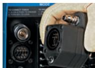
Плазматрон с разъемом Ultra-Quick Connect™ XT60 с эргономичной ручкой и гибким кабелем делает комфортной работу оператора (детальная информация на стр. 4).
