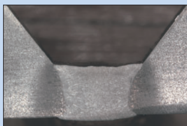
Сварка RMD® углеродистых сталей
