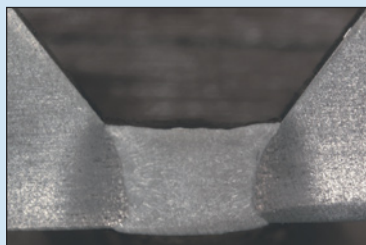
Сварка RMD® углеродистых сталей
