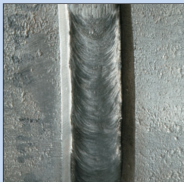
Сварка нержавеющей сталей
