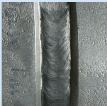
Сварка нержавеющей сталей
