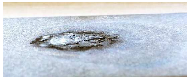
Точечный сварной шов снят
