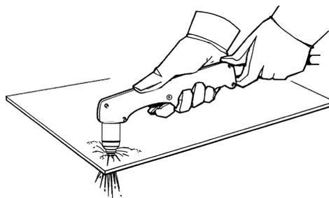
5. После завершения прожига слегка проведите соплом вдоль заготовки для продолжения резки.
