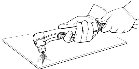
**3.** Сохраняйте угол примерно  $45^\circ$  к заготовке при переносе дуги в область строжки.
