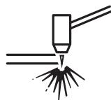
Для резки материалов толщиной более 6 мм включите резак на краю заготовки, чтобы продлить срок службы расходных деталей.
