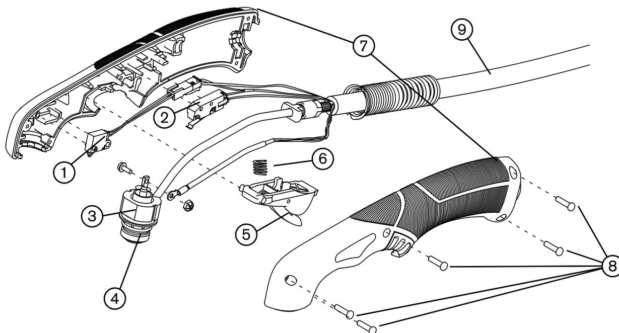
Можно заменить весь узел ручного резака и провода, или заменить отдельные компоненты резака.
