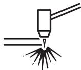
Для резки материалов толщиной более 6 мм включите резак на краю заготовки, чтобы продлить срок службы расходных деталей.
