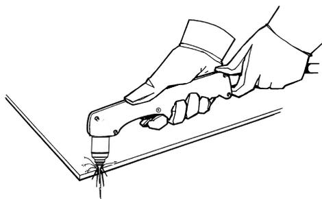
3. Для продолжения резки слегка проведите наконечником резака поперек заготовки. Поддерживайте постоянный и равномерный темп.
