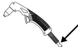
Проверьте провод резака. Замените в случае повреждения.
