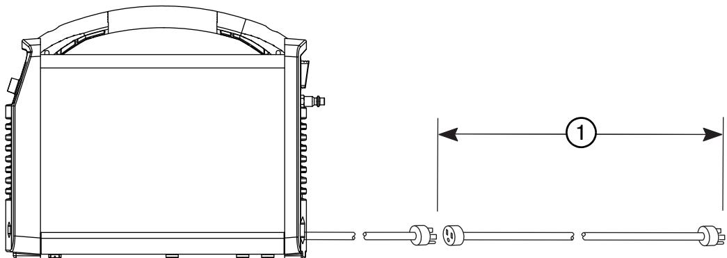
Используйте удлинитель с сечением проводов, подходящим для длины кабеля и напряжения системы. Следует использовать шнур, который отвечает государственным и муниципальным электротехническим нормам.
