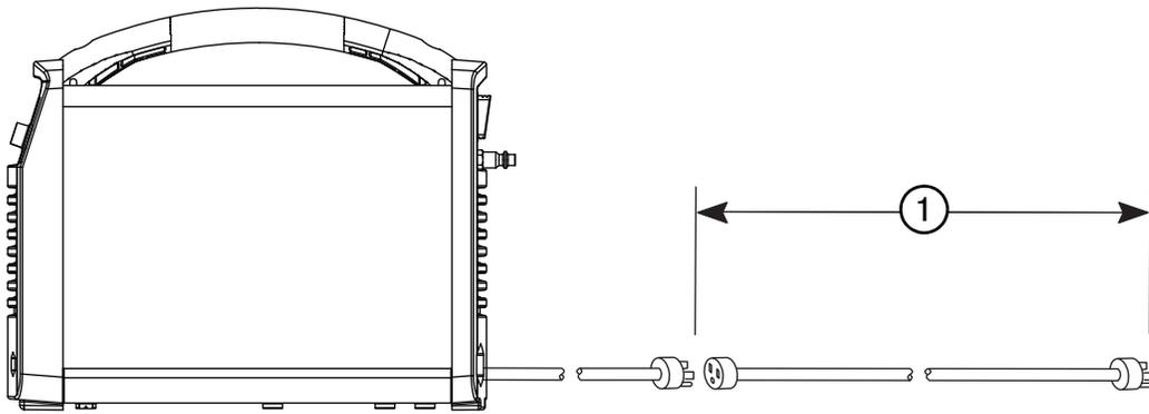
Используйте удлинитель с сечением проводов, подходящим для длины кабеля и напряжения системы. Следует использовать шнур, который отвечает государственным и муниципальным электротехническим нормам.
