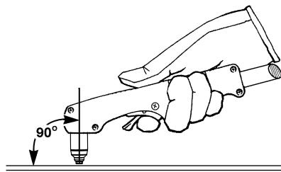
2. Нажмите выключатель резака, чтобы зажечь дугу. Возможно, потребуется задержать резак на краю, пока дуга не прорежет заготовку насквозь.
