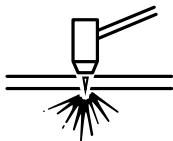
Если толщина металла меньше 6 мм, для резки внутренних элементов используйте прожиг. Этот метод уменьшает срок эксплуатации расходных деталей.
