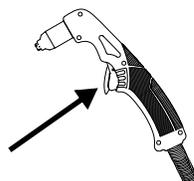
Проверьте выключатель на предмет отсутствия повреждений. Проверьте корпус резака на отсутствие трещин и открытых проводов. Замените все поврежденные детали.
