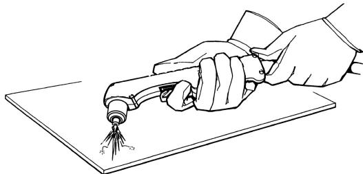
**4.** Удерживайте резак в этом положении, продолжая нажимать выключатель. Выход искр из-под заготовки означает, что прожиг металла дугой выполнен.
