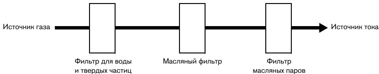
Система фильтрации должна быть установлена между быстроразъемной муфтой и источником тока.
