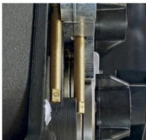
**Новый механизм протяжки** делает операцию заправки новой катушки более простой и не деформирует проволоку на всем пути к подающим роликам. Просто пропустите сварочную проволоку между шпильками и подающими роликами.
